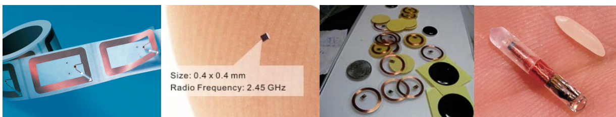
Abbildung 2: Je nach Einsatzbereich besitzen die Tags eine sehr unterschiedliche Form und Grösse.
