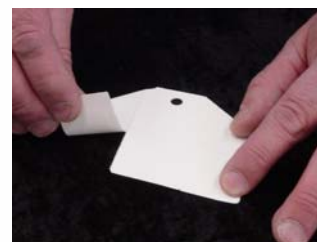
Abbildung 3: Von IBM entwickelter «Clipped Tag». Der grösste Teil der Antenne kann vom Verbraucher entfernt werden. Dadurch sind die im Tag enthaltenen Daten vor unerlaubtem Auslesen geschützt. Der Tag kann bei Bedarf (z.B. Produktgarantie) aber weiterhin aus einer Reichweite von weniger als 5 cm gelesen werden.
