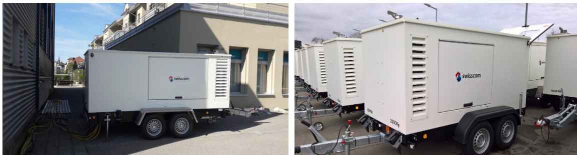
Abbildung 9: Typische mobile Diesel-Notstromaggregate unterschiedlicher Kapazität.
