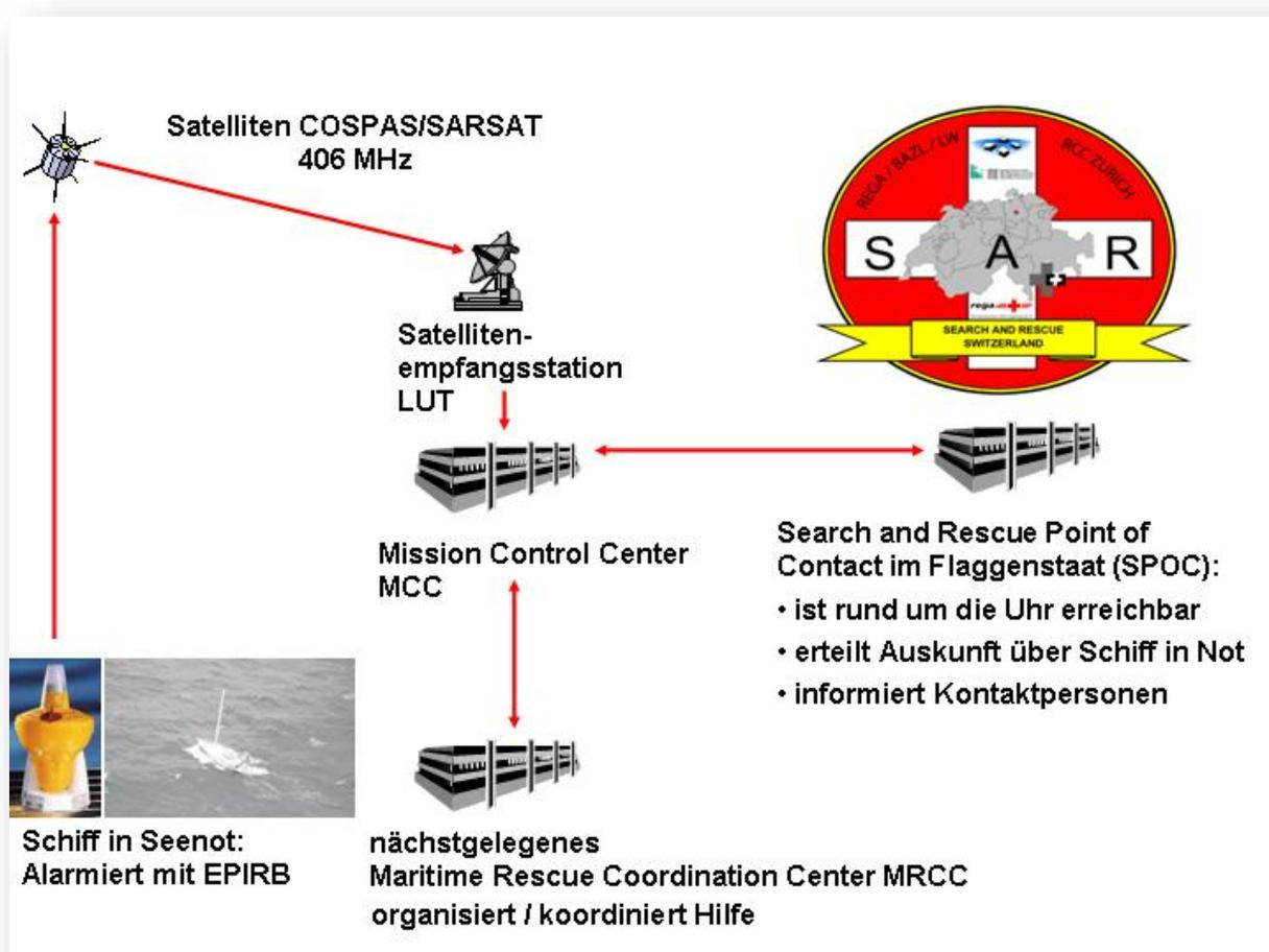
Die von einem der COSPAS SARSAT Satelliten empfangenen Signale einer EPIRB werden via Local User Terminal (LUT) und Mission Control Center (MCC) an das der Notfallposition zuständige Maritime Rescue Coordination Center (MRCC) weitergeleitet.
