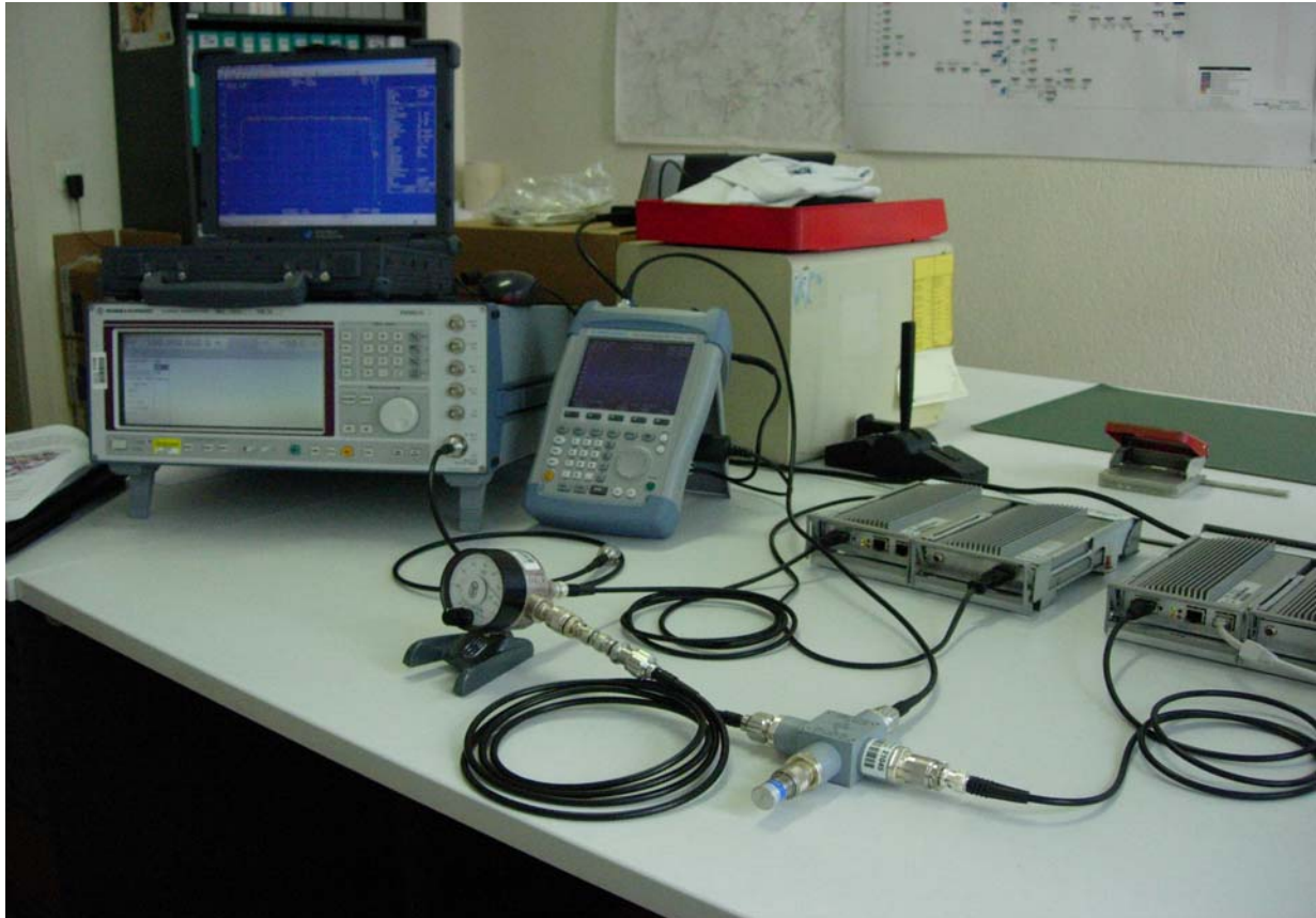
Abbild 02: Foto vom Messaufbau PLC 2. Generation
