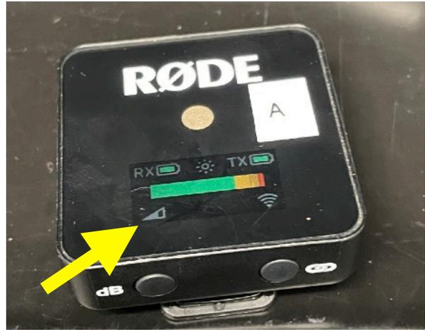
Empfänger von Røde. Das Signal wird mit der dB Taste in verschiedenen Stufen geregelt. Das Volume-Symbol zeigt die Stufe an.
