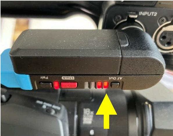
Ein Funkempfänger von Sennheiser. Das Signal, das vom Empfänger in den Toneingang der Kamera geht, kann mit der Taste AF Out in vier Stufen geregelt werden. Hier steht es auf Stufe 2 von 4.
