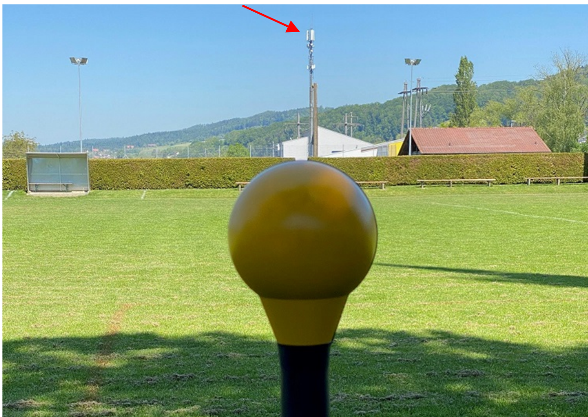
Photo 5: Basisstation (roter Pfeil) und Messantenne
